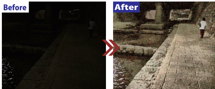
暗所における河川監視映像において、川端を歩く人の服装の色まで識別可能になります。
